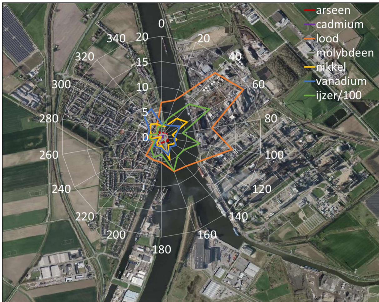
Figuur 4. Pollutieroos van arseen (rood), cadmium (paars), lood (oranje), molybdeen (grijs), nikkel (geel), vanadium (blauw) en ijzer (groen) voor meetstation Sluiskil. De as in de grafiek geeft de gemiddelde concentratie (ng/m 3 ) per windrichting van 20°.
